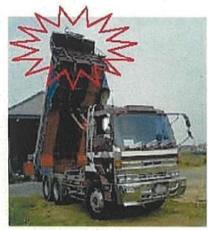
◀ ダンプカーが荷台をあげたまま踏切を通過し架線に触れ感電
