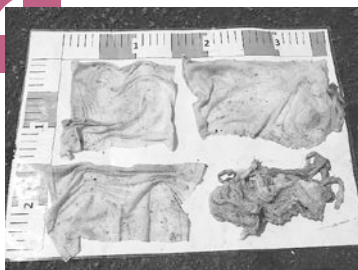
お掃除シートは水に溶けませんので、マンホールポンプの詰まりの原因となります。
