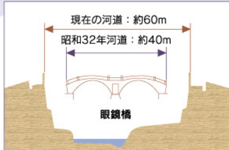
昭和32年と現在の河道断面比較図（眼鏡橋付近）
