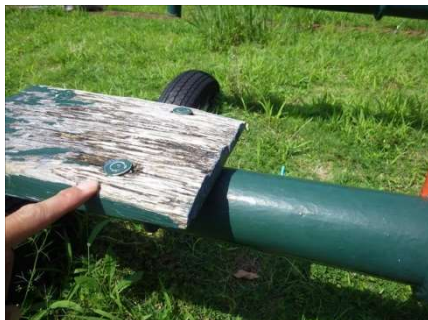
(船津児童遊園シーソー座板腐食)
