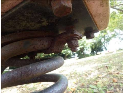
(泉公園スプリング遊具ボルト等腐食)
