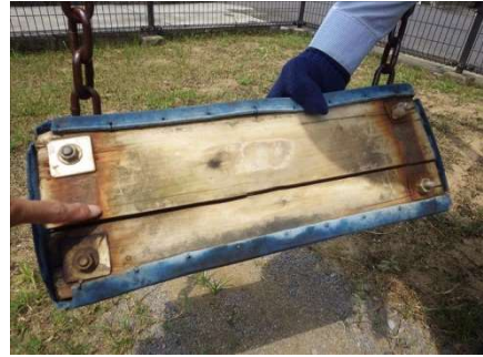
(原口町第 1 開発公園ブランコ座板破損)
