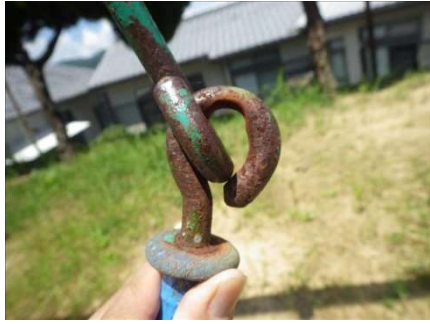
(丸尾2区第1公園2連ブランコ吊金具摩耗)
