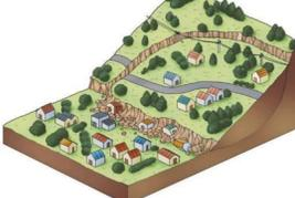
雨水が地面にしみこみ水の力によって持ち上げられた地面にわたりゆくりと動きだす災害です。
