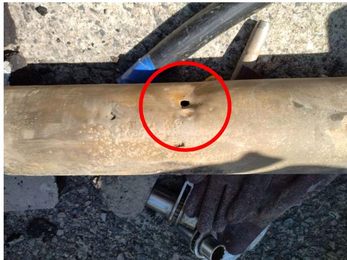
直径1cm程度の穴が開き、水道水が埋設管へ流入した。
