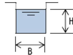
注) 流路断面積について、開水路の場合は8割水深、管路の場合は満水状態として算出する。
